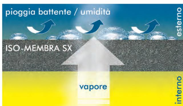
Principio di funzionamento membrana di tenuta
